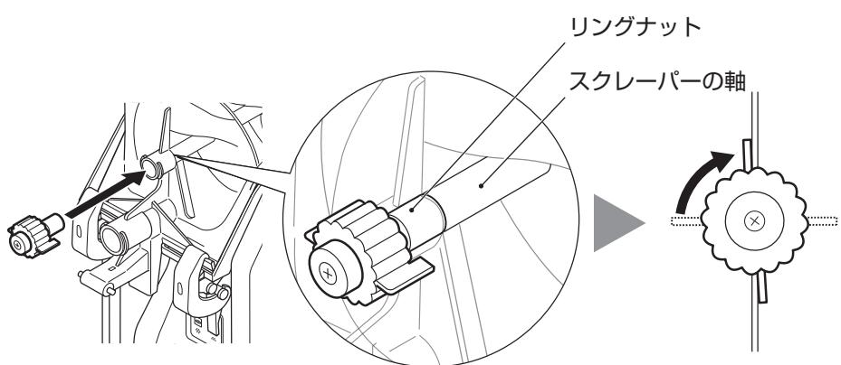
リングナットを時計方向に回し、固定します。
